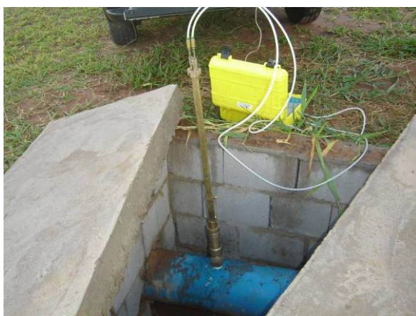
Figura 80. Tubo Pitot inserido em uma tubulação e conectado a um equipamento que contém um sensor de diferencial de pressão
