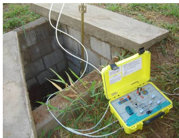
Figura 81. Tubo Pitot inserido em uma tubulação e conectado a um equipamento que contém um sensor de diferencial de pressão
