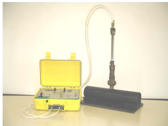
Figura 79. Tubo Pitot inserido em uma tubulação e conectado a um equipamento que contém um sensor de diferencial de pressão
